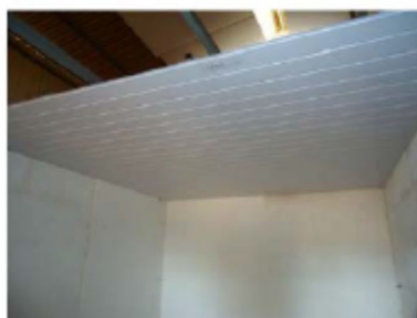
Amostra LAB 631 instalada – forro constituído de perfis de PVC modelo 200x8mm duplo
